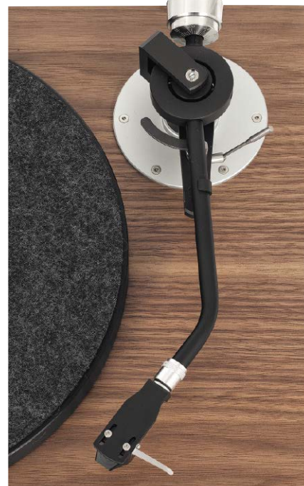
W komplecie regulacji nie zabrakło kąta VTA - wysokość kolumny możemy zmieniać po poluzowaniu blokad w dolnej części korpusu.
