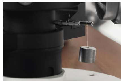
Regulacja anti-skatingu (układ z żyłką) wymaga trochę gimnastyki.
